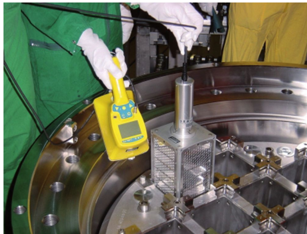
CoMo 的特殊检测器 ( 4 个活性检测器表面 ) FE-存储污染检查
